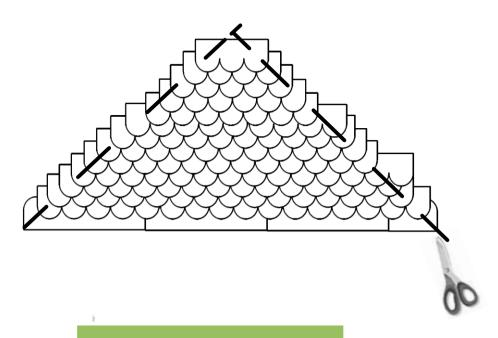
CUT THE SCHINGLES TO THE SHAPE OF THE ROOF (ALONG THE JOINING LINES OF THE SEGMENTS)
